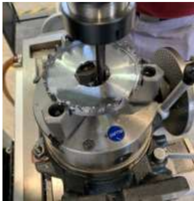
Gambar rajah 15. Proses slotting tengah gegancu
