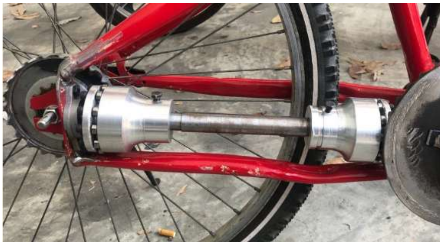
Gambar rajah 19. Komponen pemasangan gegancu muka pada basikal pandangan sisi.
