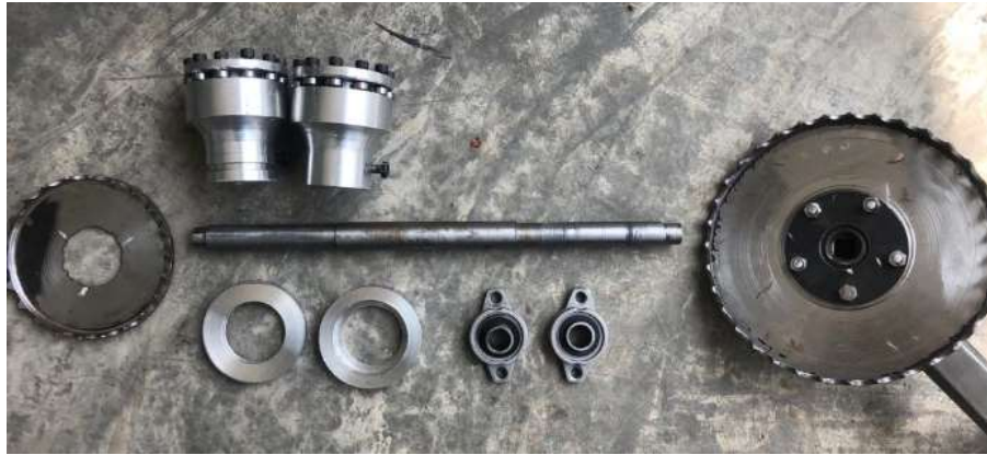
Gambar rajah 20. Komponen gegancu yang telah siap proses pemesinan.
