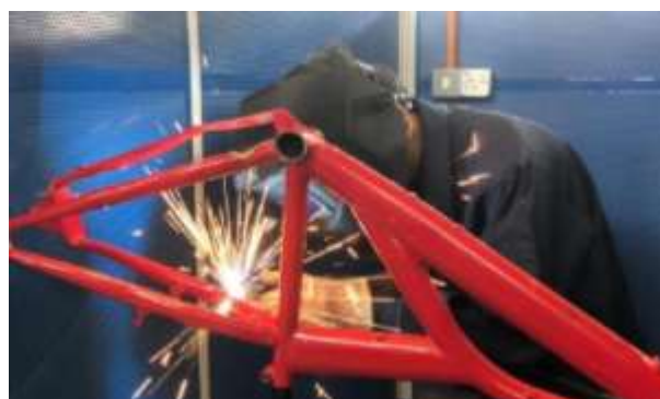
Gambar rajah 17. Proses mengubahsuai rangka basikal
