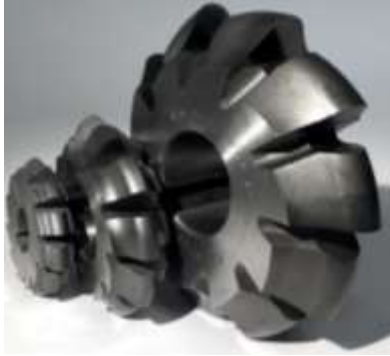
Gambar rajah 13. Mata alat pemotong gegancu
