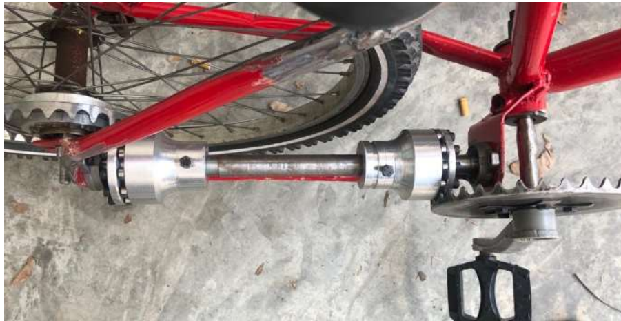
Gambar rajah 18. Komponen pemasangan gegancu muka pada basikal pandangan atas.
